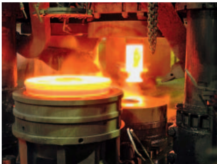
Bild 3: Warmumformung eines Stahlblocks und Warmformgebung des Rades
